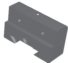
In zusammengebautem Zustand mit Pos. 8 gebohrt
